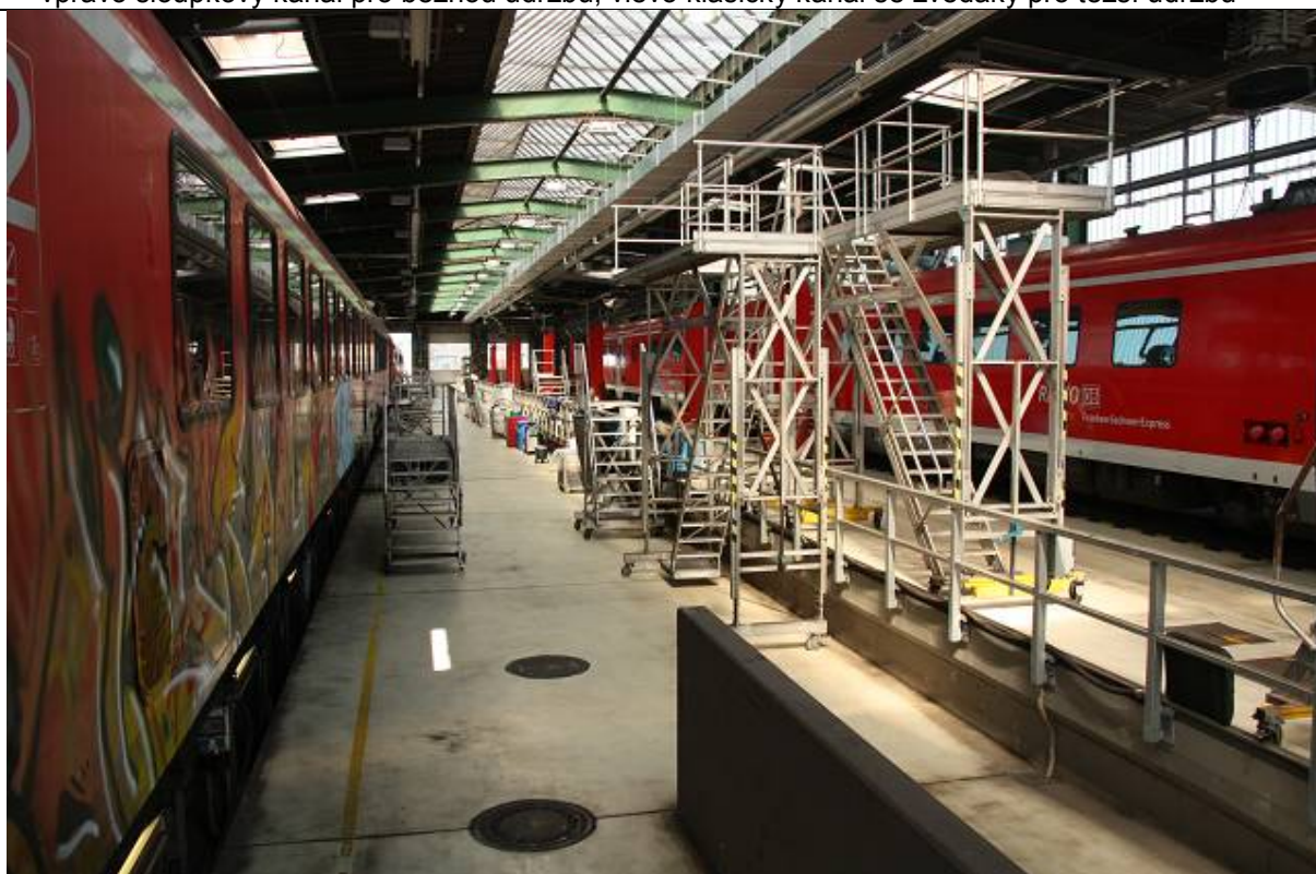
Obr: 15. Montážní lávky v provozní hale
