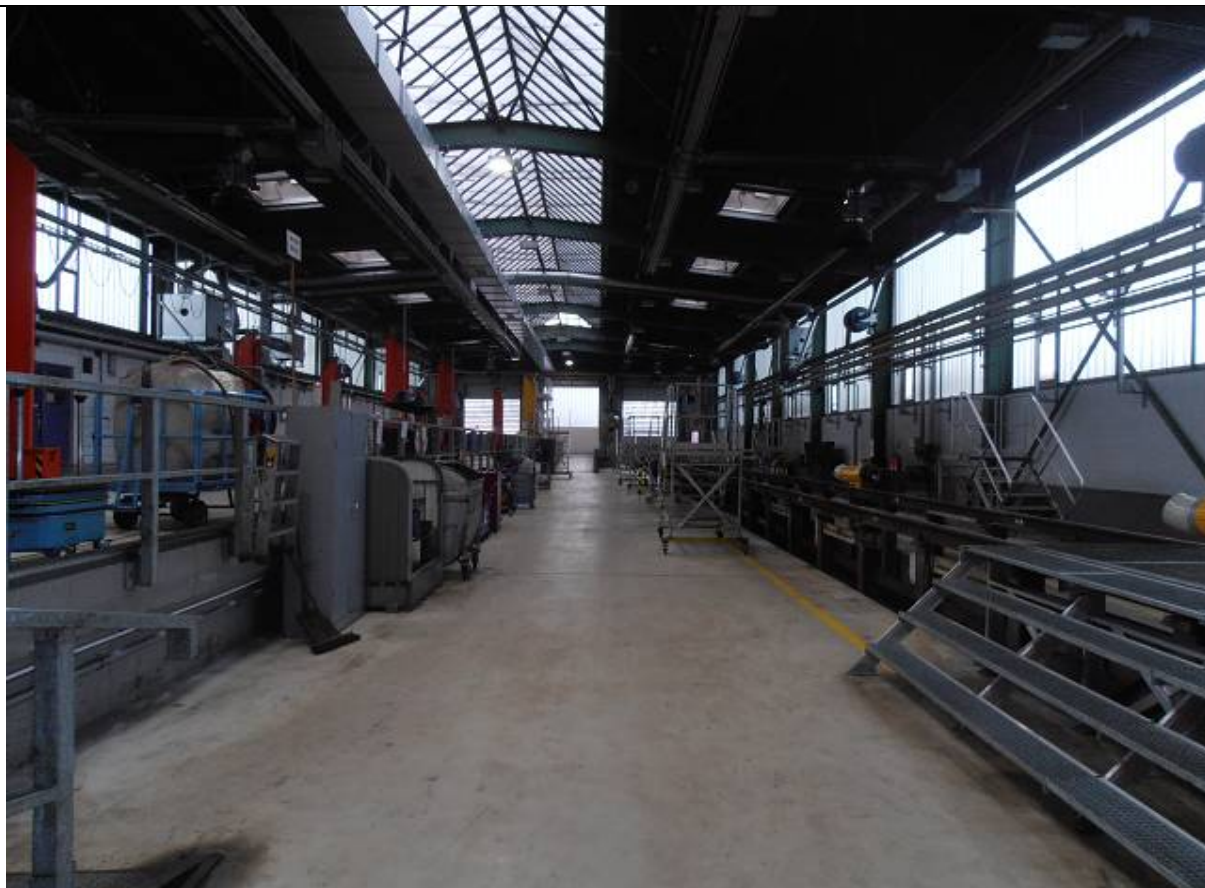
Obr: 14. Pohled do haly provozního ošetření vpravo sloupkový kanál pro běžnou údržbu, vlevo klasický kanál se zvedáky pro těžší údržbu
